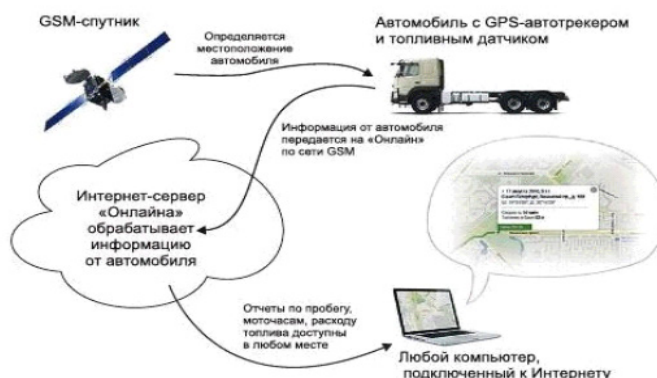
Рис. 2. / Fig. 2. Принципы работы системы мониторинга транспортных систем GPS / ГЛОНАСС.
