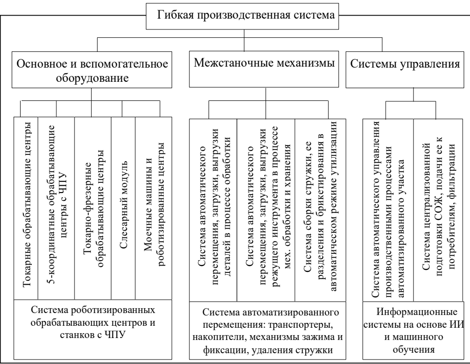
Рис. 1. / Fig. 1. Технологический состав гибкой производственной системы промышленного предприятия / The technological composition of the flexible manufacturing system of an industrial enterprise
